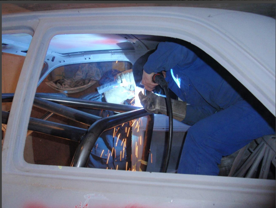
Schweißen der Dachstreben
