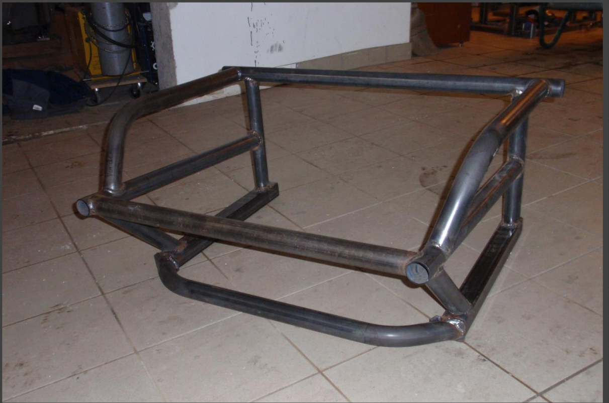
Fertig geschweißter Vorderwagen
