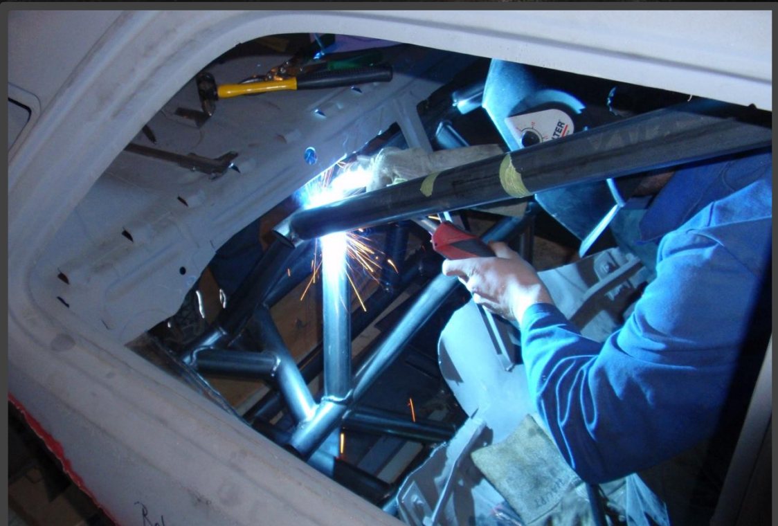
Einbau des Heckrahmens
