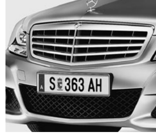
Luftleinlass mit Rautengitter
