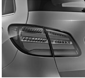
Heckleuchten in LED-Technik (Bestandteil der LED High Performance-Scheinwerfer (632))
