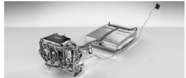
Lithium-Ionen-Hochvolt-Batterie, Ladegerät, Fahrzeugsteckdose
