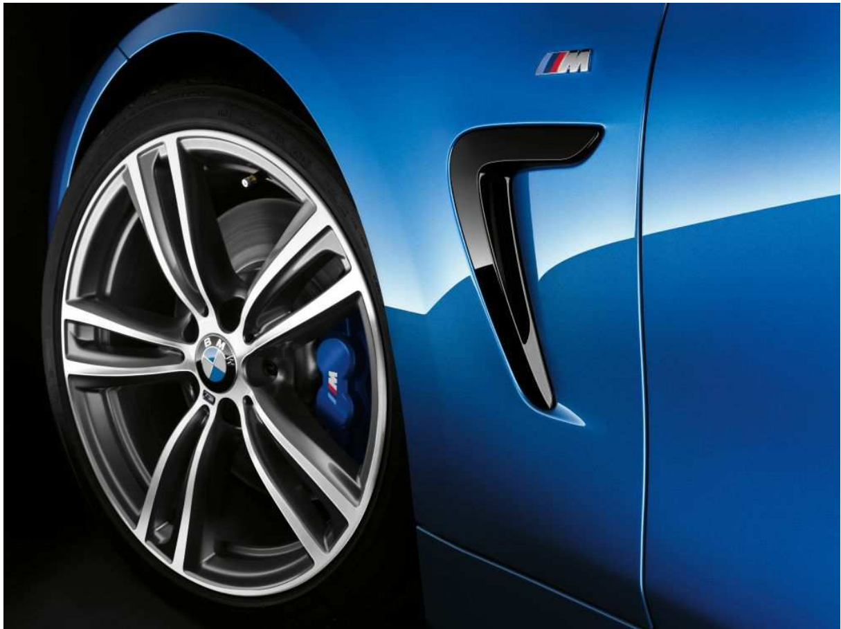
Als neue Elemente weist das BMW 4er Coupé hinter den vorderen Radläufen so genannte Air Breather auf, die den Luftwiderstand im Bereich der Radhäuser reduzieren (Alle Fotos: BMW Group)
